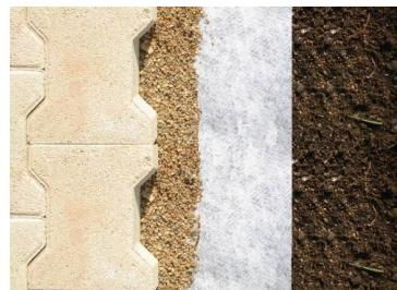
Géotextile non tissé calandré de fibres polypropylène et polyester haute densité. Complètement imputrescible et élaboré sans liant chimique, il est atoxique et respecte l'environnement. Séparation anti-contaminant, permettant de limiter la quantité de matériaux d'apport. Renforce, filtre et stabilise lors de la création de voies, d'aire de stationnement, stockage ou construction. Dans le cas de présence de végétaux résistant, utiliser notre géotextile GÉO350.
