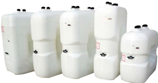
Réservoir autoportant avec bossages autorisant la suppression des bandages métalliques. Idéals pour du stockage aérien. Simples à transporter et à monter. Faciles à installer presque partout. Diverses possibilités d'installation. En PEHD soufflé en une seule pièce. Insensibles aux écarts normaux de température. Translucides, jauge non nécessaire. Poignées de manutention.
