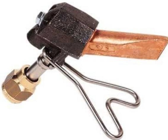
Lance pour fers de couvreur avec panne compacte, légère et silencieuse, flamme enveloppante type Cercoflam. Montée en température très rapide. Importante économie d'énergie. Corps en fonte acierée avec traitement anti-corrosion. Pied 2 positions à effet ressort. Lance adaptée au travail du zinc, du cuivre, de l'inox, du zinc pré-patiné et du plomb.
