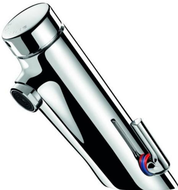
Mitigeur temporisé de lavabo, à poser sur plage, avec sélecteur de température latéral. Fermeture automatique temporisée 15 secondes, et débit 5L/mn ajustable selon la pression du réseau. Livré avec flexibles inox et fixation renforcée par 2 écrous. Avec robinet d'arrêt, raccords femelle 3/8". Garantie 10 ans.
