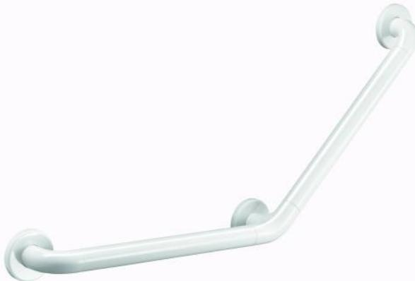
Poignée à 135° pour WC, douche ou baignoire. Utilisation comme barre d'appui (partie horizontale) ou de relèvement (partie à 135°). Utilisable à droite comme à gauche. Polyamide nylon haute résistance avec renfort en acier traité anti-corrosion 2 mm. Traitement anti-UV. 3 points de fixation, fixation invisible par platine 6 trous 73mm avec vis inox pour mur béton. Garantie 10 ans.
