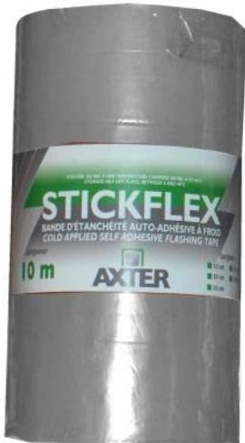
La bande StickFlex® est composée d'un bitume élastomère auto-adhésif, autoprotégé en surface par une feuille d'aluminium. La sous-face adhésive est protégée par un papier siliconé pelable. La bande épouse parfaitement les formes du support. Le bitume élastomère et la protection le rendent parfaitement flexible et étanche. Excellente adhérence sur la plupart des supports : métal, pierre, béton, bois, fibre ciment, zinc, aluminium, bardage...
