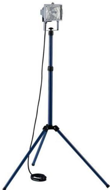
Pied télescopique réglable de 0,7 m à 2,0 m grâce à ses éléments coulissants munis de vis de blocage. Pied en tube acier peint et cuit au four. Equipé d'une grille de protection. Fourni avec 1 lampe halogène à économie d'énergie 400W, douille R 7s. Câble 3m (H07RN-F3G1,0). Conforme à la norme NF EN 60598-2-5.
