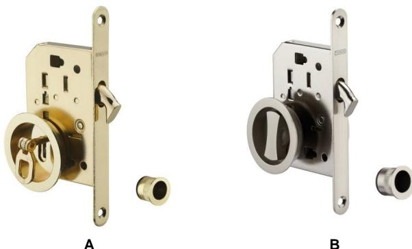
Coffre acier embouti épaisseur 11 mm pour porte coulissante. Tête acier bouts ronds. Pêne crochet. Gâche plate acier. Poignées cuvette et tirage sur champs (sauf version à cylindre). Modèle à condamnation : Carré de 8 mm, ensemble verrouillage/ déverrouillage. Pour porte épaisseur 50 mm maxi. Peut-être à condamnation, à clé articulée ou à cylindre avec un finition chromé satin ou laitonné.
