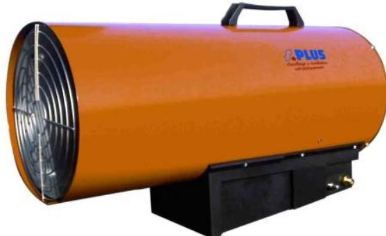
Petit appareil de chauffage portable, le générateur d'air chaud fonctionne au propane. Combustion directe, propre et sans odeur, rendement de 100%. Allumage piézo, puissance réglable, sécurité avec contrôle de flamme, sécurité de surchauffe, carrosserie double enveloppe.
