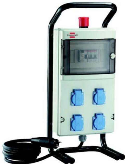
Protection par 1 interrupteur différentiel 30mA – 25 A 230V. 2 disjoncteurs divisionnaires 16 A/230V. Un dispositif d'arrêt d'urgence. Double pied soudé pour une parfaite stabilité. Poignée de transport longitudinale. 4 prises 2 P+T 16A/230V. Alimentation par 2m de câble H07 RN-F 3G2,5 avec fiche 2 P+N+T 16A/230V.
