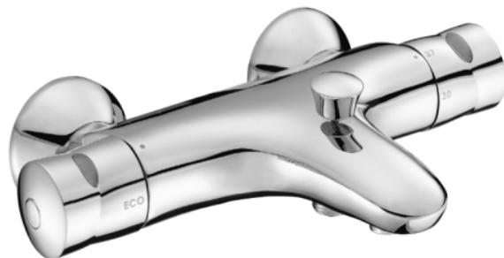
Mitigeur thermostatique bain/douche mural avec inverseur automatique. Economiseur d'eau. Butée de sécurité à 38°, blocage température maxi à 50°C. Clapets anti-retour sur les alimentations. Aérateur anti-calcaire. Fonderie compartimentée (pas de zone chaude sur le corps du robinet). Cartouche thermostatique à cire dilatable. Avec écrous et rosaces murales. Entraxe: 150 ± 15mm. Débit: 20L/mn. Saillie du bec 180mm.
