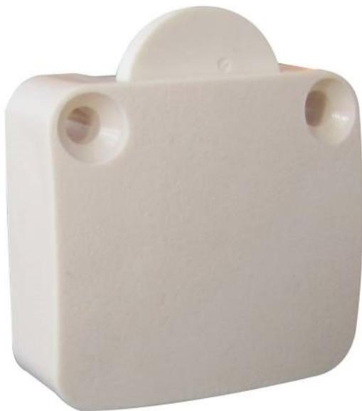
Puissance 500W 2A maxi sous 230V. En saillie. Fixation et connexion à vis. S'installe sur le montant d'une porte pour un allumage automatique à l'ouverture, la lumière se déclenche lorsque le bouton est sorti.
