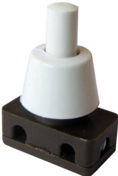
Puissance 460W 2A maxi sous 230V. A encastrer, trou diamètre 12mm, profondeur 8mm. Fixation par écrou. Connexion à vis. Se monte sur un moulin à café, par exemple, le contact se fait en maintenant le poussoir enfoncé.
