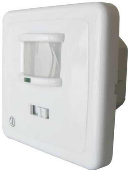
Remplace un inter classique, pour l'allumage automatique par passage devant la cellule et/ou par le bruit, d'un appareil d'éclairage 40 à 500W maxi (sauf fluo et led). 4 positions: on-off-IFR-IFR+micro. Angle horizontal 140°. Temporisation (5" à 7'), luminosité et sensibilité sonore réglables.
