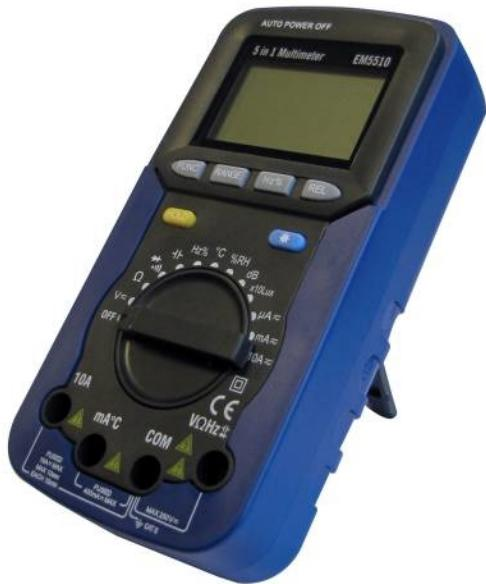
Appareil 5 en 1: testeur, thermomètre, décibelmètre, hygromètre, luxmètre. 7 fonctions, mesure de : tension 600VAC/DC, intensité 10A maxi AC/DC, résistance (ohmmètre) 40M Ohms, continuité avec buzzer, diode, capacité et fréquence. Calibrage automatique : évite à l'utilisateur de chercher la gamme la plus élevée ou la plus proche possible. Equipé d'une coque anti-choc. Pile fournie. Livré avec sacoche de transport.
