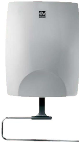
Facile à installer. Fixation par vis et chevilles au mur. Cordon d'alimentation de 2 mètres. Accessoire support de serviette fourni. Sélecteur de puissance de la résistance électrique. Fonction hors-gel. Résistance à paliers à aiguilles avec limiteur thermique à réarmement manuel. Indice de protection IPX3. Isolation électrique Classe II.
