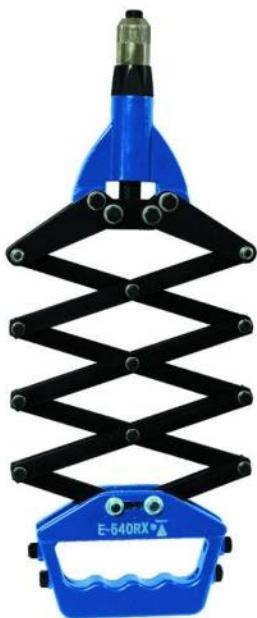
Un outil de montage idéal qui requiert un minimum d'effort physique, même en cas d'utilisation intensive pour la pose des rivets aveugles (3 à 6,4mm alu, acier, inox). S'utilise d'une seule main. Très bonne démultiplication pour faciliter le sertissage des rivets. Corps en aluminium moulé, poignée en acier.
