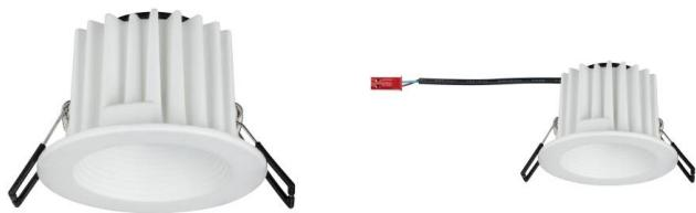
Simples à installer et conçus pour durer, ils vous apporteront un éclairage de qualité pendant de nombreuses années : durée de vie 30 000 heures environ. Angle de rayonnement de 30 degrés. Diamètre de montage : 68mm. Profondeur d'encastrement: 70mm. Dissipateur thermique intégré, système de connexion enfichable. Puissance lumineuse : 505 lumens.
