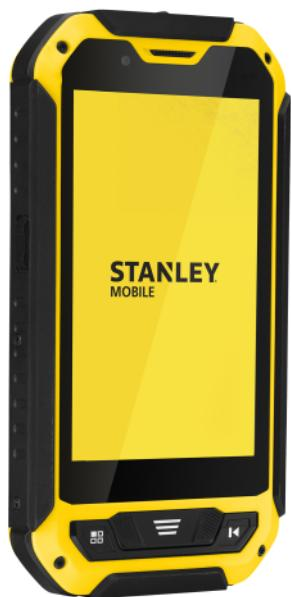
Taille de l'écran 4", résolution 480x800 pixels. Capacité de la batterie 3200 mAh, autonomie en veille 3G: 200h, autonomie en communication 3G: 16h. ROM 8GB, 5GB d'espace interne disponible, RAM 1 GB, extension de mémoire Carte SD jusqu'à 32 GB. Bluetooth 4.0. Appareil photo Arrière 5 MP / Avant 0.3 MP, lecteur Audio MP3/IMY/WAV/AAC/MID/MIDI/AMR, lecteur Vidéo MP4/3GP/AVI. Fonctionnalités incluses Lampe torche, agenda, Talkie-Walkie. OS Android 4.4. Indice de protection Certifié IP67.
