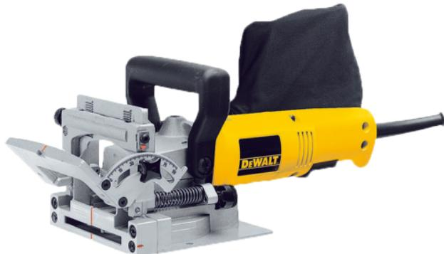
Semelle galvanisée antidérapante, huit rainures de guidage et guide à fenêtre pour un travail de précision. Points de réglage fixes pour lamelles 0, 10, 20. Réglage en hauteur du guide à onglet entre 0° et 90° pour des épaisseurs de 10 à 70mm.
