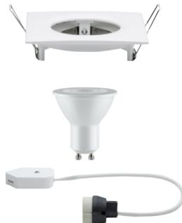
Encastrés LED Nova. Les spots encastrés ont une protection IP44 spécifique qui empêche la pénétration des projections d'eau, ils conviennent donc parfaitement aux locaux humides. Ils s'installent facilement à l'intérieur de la bague de montage grâce à un bornier. Luminaire individuel. Ampoule LED amovible incluse. Température de couleur: 2700K - Blanc chaud. Pour raccordement direct au secteur 230V.
