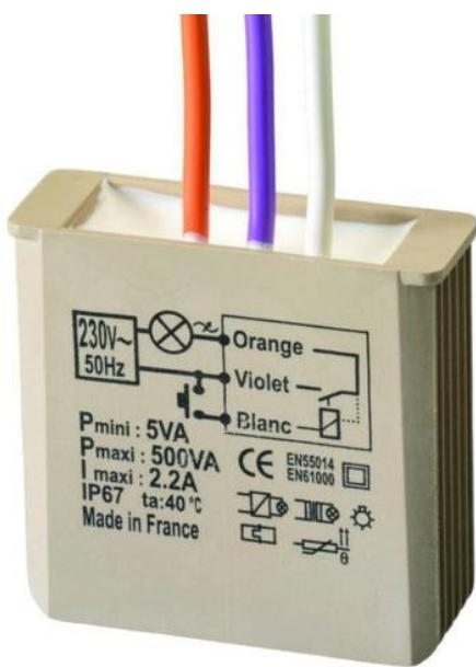
Micro-module télérupteur encastré. Le micro-module est électronique et miniature. Il peut se placer derrière un interrupteur existant pour commander un circuit d'éclairage à partir d'un ou plusieurs poussoirs. Compatible avec les câblages existants avec le commun des poussoirs au neutre ou à la phase. Augmente la durée de vie des ampoules et des interrupteurs grâce à la fonction "soft start".
