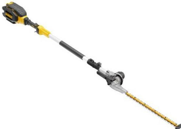
Taille-haies télescopique XR 36V Brushless. Moteur Haute Performance sans charbon avec carter métal. Tube télescopique 106-152 cm pour une portée étendue et pour manoeuvrer plus facilement. Lame double action 50cm avec 25mm de capacité de coupe
