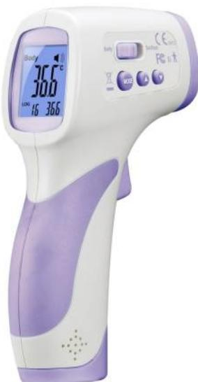
Mesure instantanée sans contact. Température corporelle de 30°C à 42,5°C. Température matériaux de 0°C à 60°C. Temps de réponse inférieur à 1s. Mémoire 32 dernières mesures. Alarme sonore/visuelle réglable. Distance optimale de 1 à 10cm. Ecran rétroéclairé. Extinction automatique.
