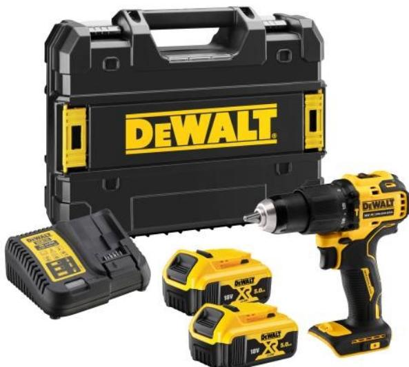
Perceuse visseuse à percussion XR BrushLess compacte avec mandrin métal. Design ergonomique, compact et léger. 175 mm de long, pour travailler dans des espaces étroits. 2 vitesses, 15 positions. Lampe LED intégrée.
