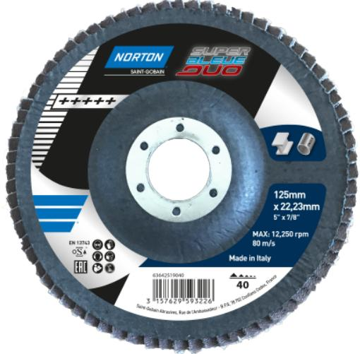
Disque à double lamelles oxyde d'aluminium céramique SG et Zirconium, conçu pour un travail à moyenne pression. Ebarbage sans échauffement sur l'acier carbone et l'acier inoxydable. Enlèvement de matière agressif, à moyenne pression, ce qui génère une coupe froide.
