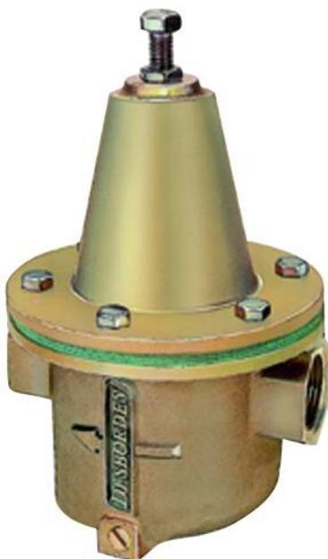
Réducteur de pression 10 BIS DN 10 à 100 F/F. Avec bouchon 1/4" de chaque côté pour montage manomètre. Corps bronze, insensible au tartre, pas besoin de filtre, aucun entretien.
