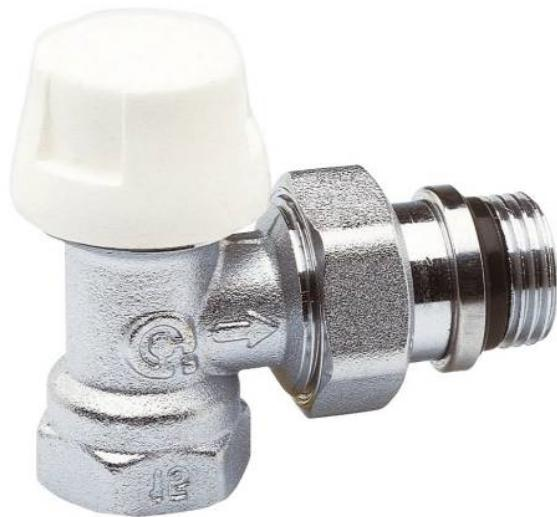
Le robinet thermostatique assure automatiquement la régulation de la température émise par le radiateur, en agissant sur le débit d'entrée de l'eau chaude. Corps laiton matricé, chromé. Axe acier inox. Joints et clapet EPDM. Élément sensible à liquide. Joint de montage sur la douille.
