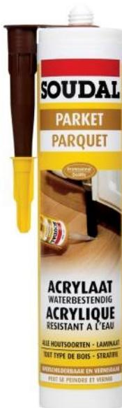
Mastic de jointage sans solvant, à base acrylique. S'utilise pour le calfeutrage de fentes et joints de parquets ou stratifiés (avec un mouvement max. de 15%). S'applique également pour la réalisation de joints de raccordement entre le parquet et les parois.
