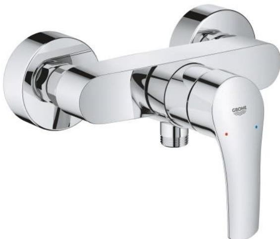
Mitigeur monocommande 1/2" douche. Montage mural apparent. Levier de commande métallique. Cartouche en céramique 46 mm avec butée éco point dur. Limiteur de débit ajustable. Débit minimal réglable à 2,5 l/min. Départ de douche 1/2" par le dessous avec clapet anti-retour intégré. Raccords muraux S. Rosaces métalliques. Limiteur de température optionnel. Avec clapets anti-retour.
