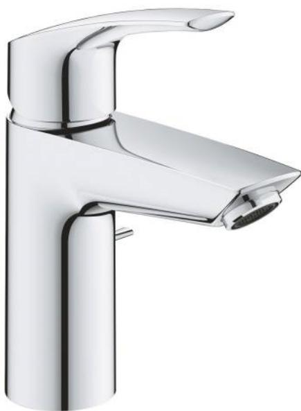
Mitigeur monocommande 1/2" monotrou lavabo. Levier de commande métallique. Cartouche en céramique 35mm avec butée éco point dur. Limiteur de débit ajustable. Débit minimal réglable à 2,5 l/min. Mousseur. Tirette et garniture de vidage 1 1/4". Flexibles de raccordements souples. Système de montage rapide.
