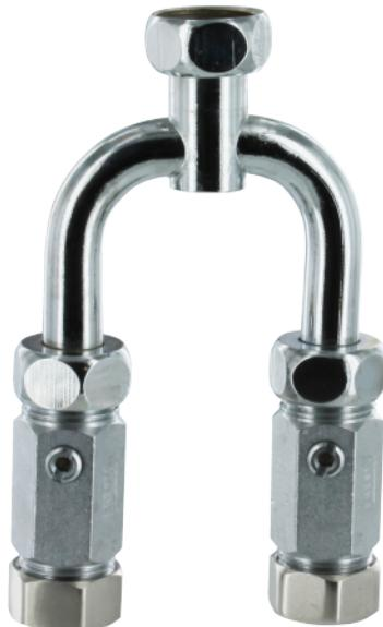
Ce robinet pré mélangeur permet de produire une eau mitigée, pour 1 poste sanitaire (lavabo, bidet), grâce aux réglages de robinets d'arrêt incorporés sur les arrivées eau chaude et eau froide. Corps et composants en laiton avec traitement nickel-chrome. Etanchéité réalisée par élastomères Nitrile/EPDM. Raccords G1/2". Entraxe 54mm. Hauteur 115mm.
