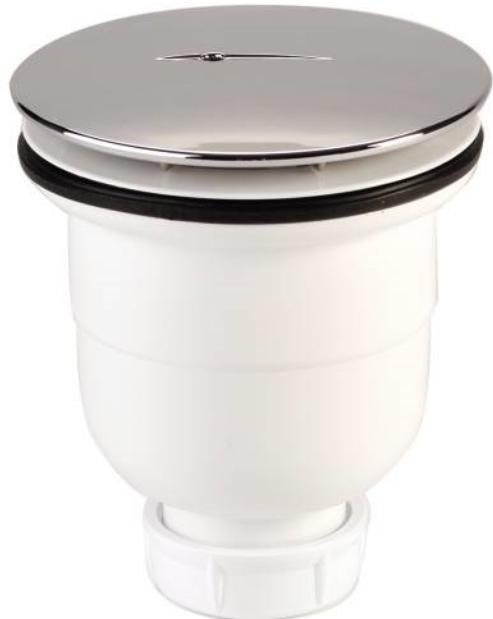
Bonde siphonique à sortie verticale. Capot ABS chromé. Sortie JC 40mm à visser ou à coller. Universelle pour tous types de receveurs de perçage 90mm.
