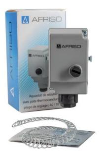
Aquastat de sécurité qui s'installe sur une tuyauterie par avec ressort de fixation. L'Aquastat est utilisé pour limiter la température dans le circuit protégé. Il est obligatoire pour la protection des planchers chauffants (DTU65.14).
