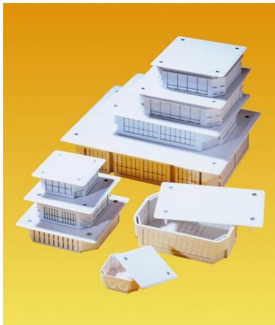
La rigidité est augmentée grâce à la nervure de renforts sur le pourtour de la boîte. Produit non propagateur de la flamme. Tenue au fil incandescent : 650°C - 30s, selon norme IEC 635-2.1.
