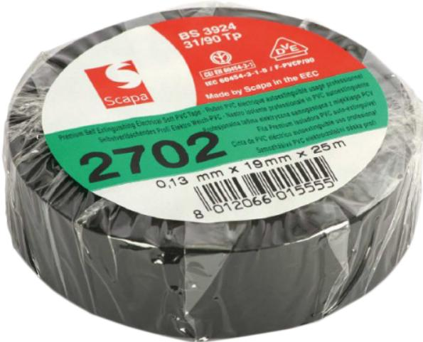
Ruban adhésif PVC, de qualité électrique et auto-extinguible, sans plomb, d'une épaisseur nominale de 0,18mm, enduit d'une masse adhésive caoutchouc agressive. Il est spécialement conçu pour toutes applications d'isolation électrique pour lesquelles une homologation internationale est requise et lorsque la sécurité environnementale est une préoccupation majeure.
