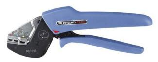
Double sertissage pour cosses pré-isolées conformément à la norme avec une tenue sur l'âme du conducteur et de l'isolant. Déverrouillage toujours accessible. Sertissage inversé: positionnement de la cosse sur la partie fixe pour une plus grande efficacité et précision. Forme permettant le calage de la main. Toucher soft. Matrice inox 3 empreintes: rouge 0,5 à 1,5mm² - bleue 1,5 à 2,5mm² - jaune 4 à 6mm².
