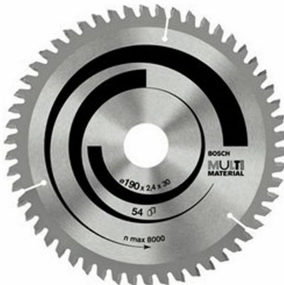
Lame de scie circulaire Multi Material permettant des coupes puissantes sur une large gamme de matériaux. Denture de qualité en carbure, affûtée avec précision, rendant la lame suffisamment robuste pour couper divers matériaux. Lame fabriquée en acier trempé SK5 avec des dimensions stables (> 40 HRC), garantissant la précision. L'alésage fonctionne avec ou sans bagues de réduction pour s'adapter à différentes tailles.
