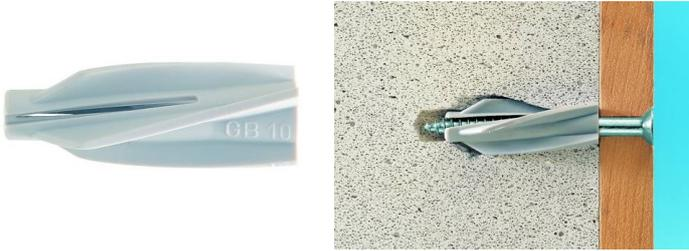
Fixation spéciale pour le béton cellulaire. Les nervures extérieures créent un verrouillage de forme dans le matériau de construction. La fixation atteint sa capacité de charge optimale uniquement lorsqu'elle est utilisée avec la vis de sécurité fischer pour des épaisseurs à fixer allant jusqu'à 280 mm.
