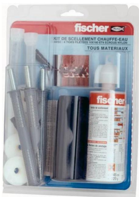
Kit composé d'une cartouche de résine FIS VS 150 C avec 1 poussoir et 2 embouts, de 4 tamis, de 4 tiges filetées, et de 4 écrous nylon. S'utilise avec tamis dans les supports creux, et sans tamis dans les supports pleins.
