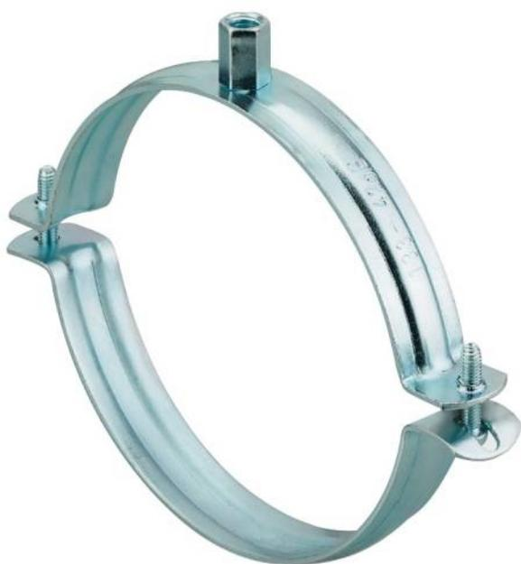
Colliers sans garniture. Double taraudage M8/M10. Large ouverture facilitant la mise en place des tuyaux. Vis imperdable à tête large et empreinte combi. 2 vis de serrage pour un meilleur ajustement du collier au diamètre du tube. Pour fixation de tuyauteries au mur, plafond et au sol dans les domaines du chauffage, sanitaire et évacuation pour les installations ne nécessitant pas d'isolation acoustique.
