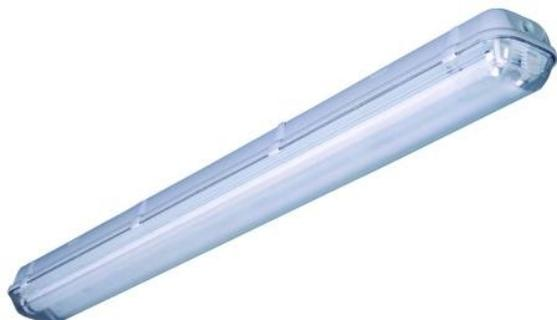
Luminaire étanche, vasque en polycarbonate injecté avec prismes longitudinaux internes et surface extérieure lisse. Joint d'étanchéité coulé en polyuréthane à cellules fermées garantissant une parfaite étanchéité dans le temps. Clips de fermeture imperdables en acier inox. Pour halls industriels, parkings souterrains, auvents, caves, passages souterrains, piscines, menuiseries, zones de stockage, aires de louage, ateliers...
