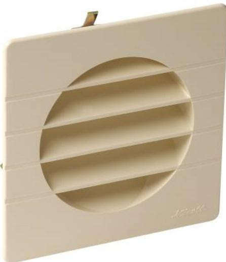
Modèle pour l'extérieur moulé dans une résine de synthèse renforcée contre les rayons ultra-violets qui présente une très bonne tenue des coloris dans le temps ainsi qu'une grande résistance aux chocs. Mise en place instantanée : des agrafes s'accrochent aux parois intérieures des tubes PVC. La dépose reste possible (pour le nettoyage par exemple). Ailettes inclinées pare-pluie.
