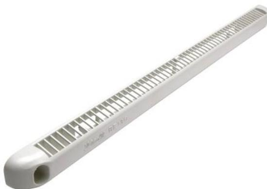
Les entrées d'air utilisées dans les chambres et pièces de séjour sont le complément indispensable des systèmes simple flux de ventilations permanentes, qu'elles soient naturelles ou mécaniques. Le régulateur est positionné à l'intérieur du logement, sortie tournée vers le haut, son corps est moulé en polystyrène choc. Ils reçoivent la languette de régulation de débit. Les vis de fixation peuvent être dissimulées par des caches.
