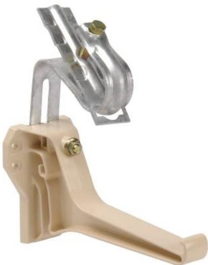
Crochet permettant de fixer une gouttière Ovation LG 28 ou LG 38 en sommet de tuile afin de laisser le canal d'écoulement dégagé.
