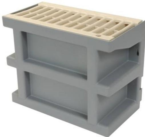
Pour la ventilation des vides sanitaires, caves, sous-sols... Grille en PVC traité anti U.V. permettant une surface de ventilation de 134 cm<sup>2</sup>. Corps à fixer au mur par vis et cheville. La hauteur de 20 cm correspond à celle d'un parpaing.
