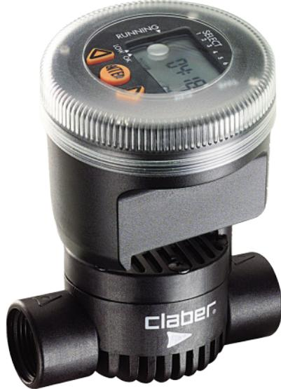
Electrovanne programmable facilement grâce à trois touches, 6 départs possible par 24 heures, programmation hebdomadaire avec possibilité d'exclusion de quelques jours. Peut s'installer en extérieur ou dans un regard. Raccord femelle/femelle 1".
