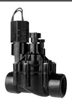
Vanne destinée aux installations d'arrosage résidentielles et publiques de petites dimensions. Vanne électrique plastique, corps en PVC. Double filtration au niveau de la membrane et du siège du solénoïde. Ouverture manuelle sans fuite d'eau par rotation d'un quart de tour du solénoïde. Ensemble solénoïde/plongeur d'une seule pièce noyé dans une résine de protection. Purge externe par vis de purge. Vis cruciformes en acier inoxydable. Alimentation par transformateur.
