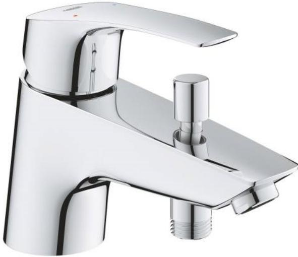
Mitigeur monocommande 1/2" monotrou bain/douche. Levier de commande métallique. Cartouche en céramique 46 mm avec butée éco point dur. Limiteur de débit ajustable. Débit minimal réglable à 2,5 l/min. Inverseur automatique bain/douche. Clapet anti-retour intégré dans le départ douche 1/2". Mousseur. Flexibles de raccordement souples. Limiteur de température optionnel. Avec clapets anti-retour.
