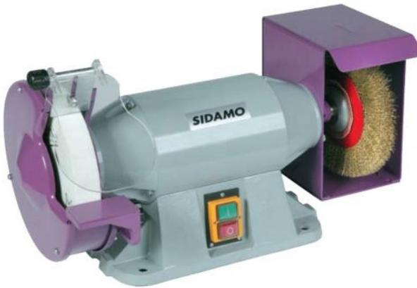
Corps en fonte d'acier. Montage sur roulements à billes étanche auto-lubrifiés. Interrupteur à bobine à manque de tension. Écran de protection en polycarbonate. Protection thermique automatique interne au moteur. Carters en acier embouti équipés d'une buse de captage des poussières. Sécurité / conformité : espace entre la meule et le carter inférieur à 5 mm. Pare-étincelles et porte outil réglables à 2 mm de la meule. Aucune ouverture sous le porte outil.
